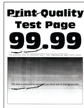
“Defecte repetitive” la pagina 246
