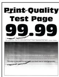
**Remarque :** Avant de résoudre le problème, imprimez les pages d'échantillon de qualité afin de déterminer la cause des défauts récurrents. Sur l'écran d'accueil, accédez à **Paramètres > Dépannage > Pages de test de qualité d'impression**.
