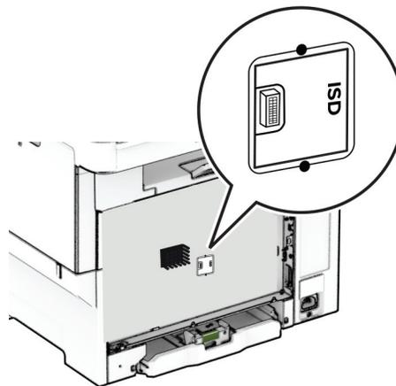
6 Insérez le disque de stockage dans le connecteur ISD.
