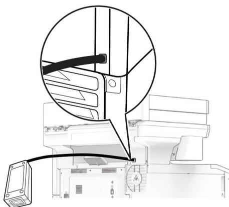
**9** Connectez une extrémité du câble d'alimentation de l'agrafeuse au bloc d'alimentation, puis branchez l'autre extrémité sur la prise de courant.
