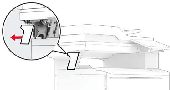
**5** Insérez l'alimentation électrique dans l'imprimante, puis raccordez-la à l'agrafeuse attenante.
