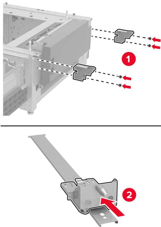
**13** Fissare la guida, quindi la staffa di montaggio e i coperchi delle guide.
