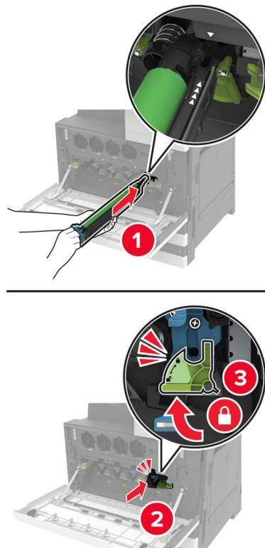
**6** Utilizzando il dispositivo di pulizia della testina, pulire la lente della testina di stampa.
