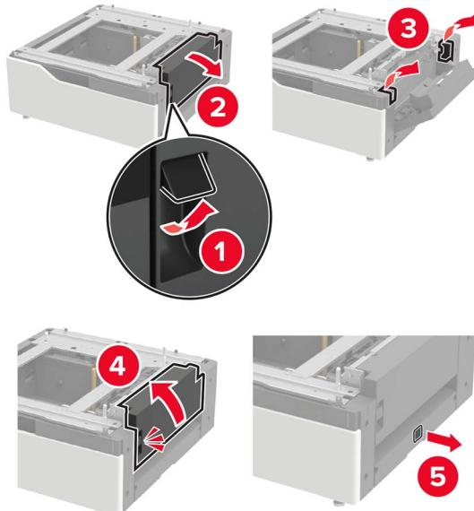
**11** Aprire il vassoio, quindi rimuovere la staffa di montaggio e le coperture delle guide.
