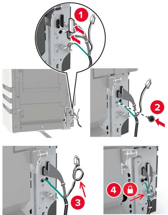
**19** Fissare il coperchio del cavo del vassoio.
