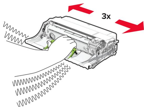
**請當心一潛藏損壞危險性：**成像組件直接暴露在光線下的時間不宜超過 10 分鐘。曝露在光線下太久，會導致列印品質發生問題。
