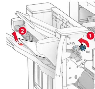
12. 以逆時鐘方向轉動旋鈕 R2，然後取出紙張傳輸蓋板 F 中的夾紙。
