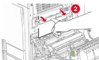
◦ 在加熱熔合組件下方
