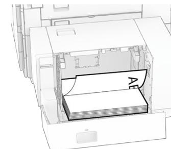
載入用於雙面列印的信頭紙時，載入信頭紙時面朝上，並將信頭朝向印表機後方。
