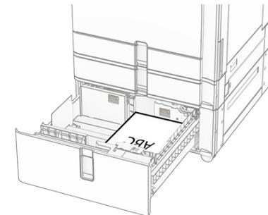
載入用於雙面列印的信頭紙時，載入信頭紙時面朝下，並將信頭朝向紙匣組件前方。
