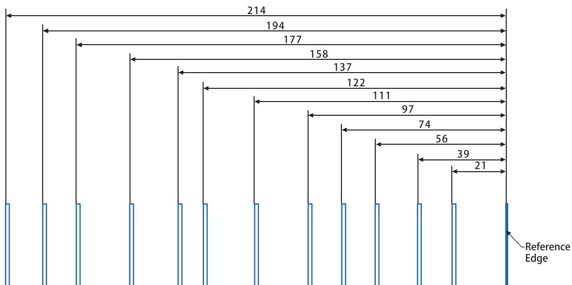
**Схема ребристых направляющих для Lexmark B2865, M5255, M5265, M5270, MB2770, MS725, MS821, MS822, MS823, MS824, MS825, MS826, MX721, MX722, MX725, MX822, MX824, MX826, XM5365, XM5370, XM7355, XM7365, XM7370**
