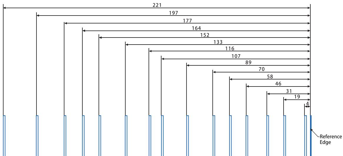
**Схема ребристых направляющих для Lexmark C4150, C4342, C4352, CS720, CS725, CS727, CS728, CS730, CS735, CX725, CX727, CX730, CX735, XC4140, XC4150, XC4342, XC4352**
