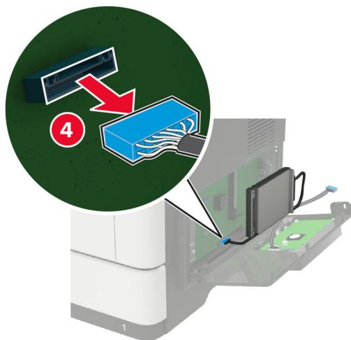
**b** Conecte el cable de extensión del ISP al conector del ISP.
