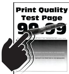
**Nota:** Antes de resolver el problema, imprima las páginas de prueba de la calidad de impresión. En el panel de control, vaya a **Configuración > Solución de problemas > Páginas de prueba de calidad de impresión**.
