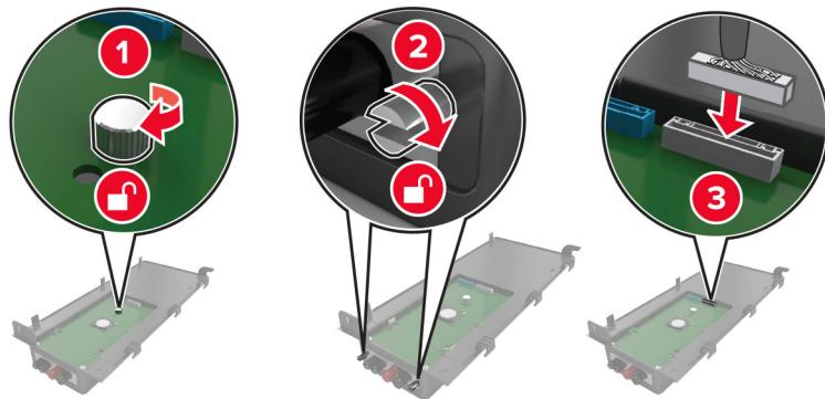
6 Abra y, a continuación, retire la cubierta de acceso a la placa del controlador.
