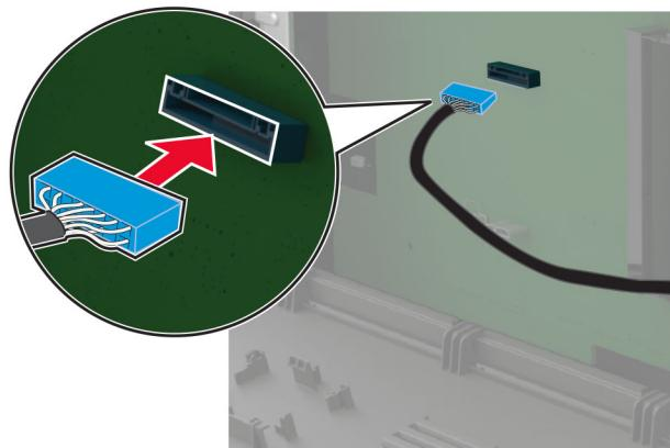
**6** Conecte el disco duro a la placa del controlador
