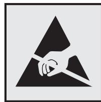
هذا الرمز يحدد الأجزاء الحساسة للكهرباء الاستاتيكية. لا تلمس المناطق القريبة من هذه الرموز دون لمس سطح معدني أولاً في منطقة بعيدة من الرمز. لتجنب حدوث تلف ناجم عن التفريغ الكهربائي عند تنفيذ مهام الصيانة مثل إزالة انحصار الورق أو استبدال المستلزمات، المس أي إطار معدني مكشوف للطابعة قبل الوصول إلى المناطق الداخلية في الطابعة أو لمسها حتى إذا لم يكن الرمز موجوداً.
