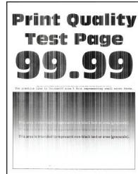
ملاحظة: قبل حل المشكلة، اطبع صفحات اختبار جودة الطباعة. من لوحة التحكم، انتقل إلى الإعدادات > استكشاف الأخطاء وإصلاحها > صفحات اختبار جودة الطباعة. في طرازات الطابعات المزودة بشاشات لا تعمل باللمس، اضغط على **OK** للانتقال عبر الإعدادات.
