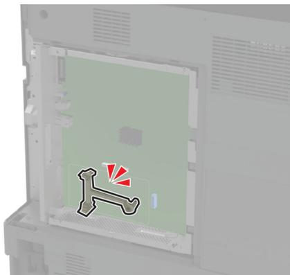
**7** Fissare l'ISP alla staffa di montaggio.
