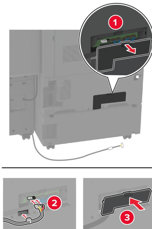
**18** Fissare il cavo lungo la parte posteriore della stampante.
