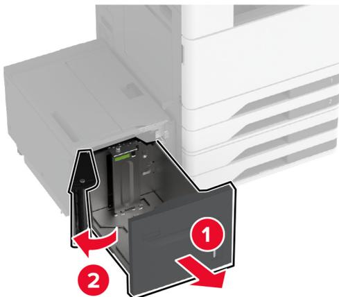
**2** Regolare la guida sul retro del vassoio. Eseguire la stessa operazione sulla parte anteriore del vassoio.
