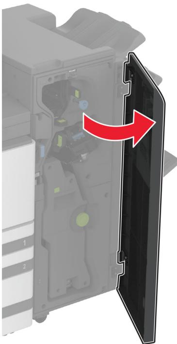
**2** Rimuovere il contenitore perforazione usato.
