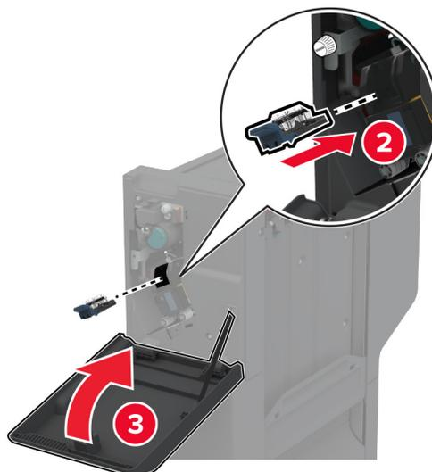
**5** A l'aide d'un tournevis à tête plate, fixez les supports à l'unité de finition.
