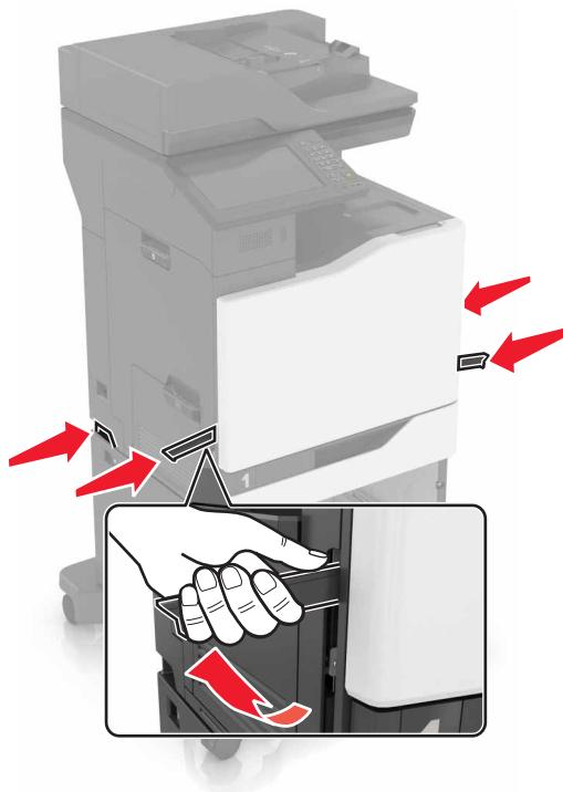
**Remarque :** Si des tiroirs optionnels sont déjà installés, déverrouillez-les sur l'imprimante avant de la soulever. N'essayez pas de soulever l'imprimante et les tiroirs en même temps.
