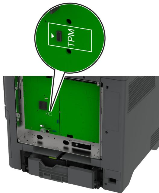
**5** Raccorder le module au connecteur TPM.
