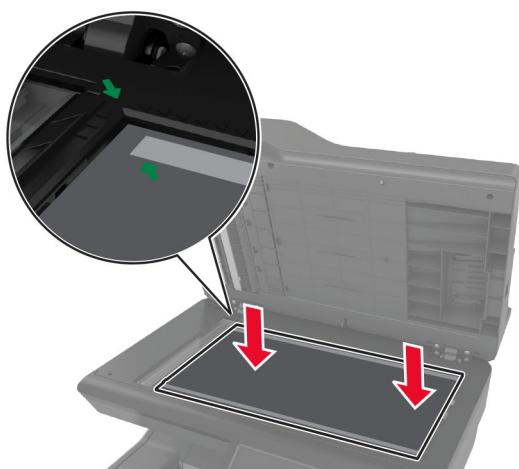
**Remarque :** Assurez-vous que le tampon de la vitre du scanner est correctement aligné aux bords de la vitre du scanner.
