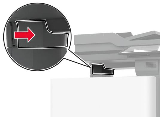
**7** Insérez l'alimentation électrique dans l'imprimante.
